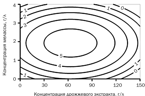
Рис. 1. Зависимость конверсии мелассы в лактат от концентраций мелассы и дрожжевого экстракта
