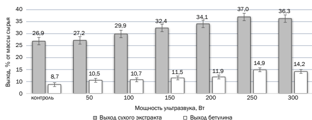
Рис. 3. Влияние мощности ультразвуковой обработки на выход сухого экстракта и кристаллов бетулина
