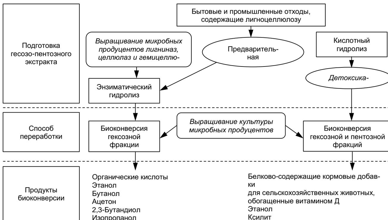
**Рис. 4. Способы биоконверсии лигноцеллюлозосодержащих отходов различного происхождения**
