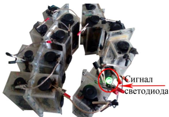
Рис. 9. Работа светодиода при последовательном соединении 7-ми биотопливных элементов в автономный энергокомплекс (среда – модельная сточная вода, биоагент – микробный препарат «Доктор Робик 109», субстрат – высушенная растительная масса E. canadensis )
