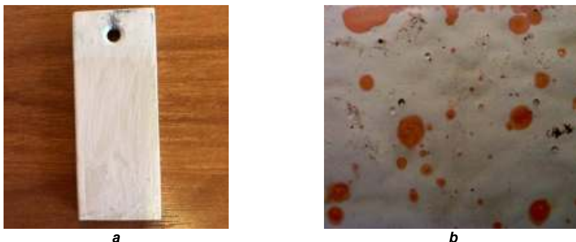
Рис. 6. Образец с нанесенной на поверхность эмалью «Ржавостоп» с белым пигментом (а); микрофотография поверхности образца при 1000-кратном увеличении, время экспонирования – 30 мин (b)
